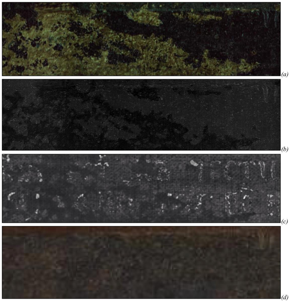
Rys. 4.2.: Wybrany fragment obszaru pomiarowego, w którym napis pozostaje niewidoczny, (a) obraz w fałszywych kolorach RGB ( R=2464.1899 nm, G=1789.45 nm, B=1022.02 nm), (b) ładunek czynnikowy NMF, który można przyporządkować do faktora reprezentującego widmo farby napisu, (c) zdjęcie RTG (foto: Michał Obarzanowski, Piotr Frączek), (d) zdjęcie w świetle widzialnym.
