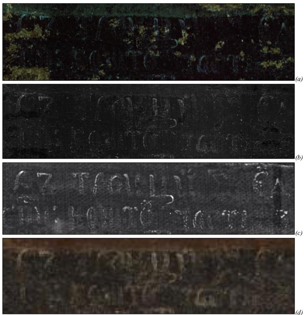
Rys. 4.1.: Wybrany fragment obszaru pomiarowego, w którym napis pozostaje względnie dobrze zachowany, (a) obraz w fałszywych kolorach RGB ( R=2464.1899 nm, G=1789.45 nm, B=1022.02 nm), (b) ładunek czynnikowy NMF, który można przyporządkować do faktora reprezentującego widmo farby napisu, (c) zdjęcie RTG (foto: Michał Obarzanowski, Piotr Frączek), (d) zdjęcie w świetle widzialnym.
